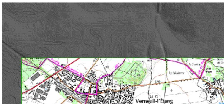
fig. 23) Illustration d'un ombrage généré sur MNT IGN 25 m qui montre les sauts de valeurs dont la trace correspond parfaitement aux courbes de niveau du SCAN25.
