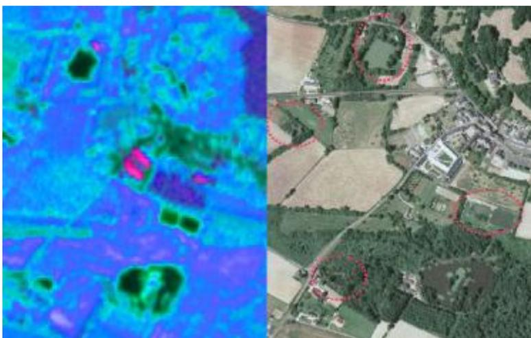
fig. 76) Illustration de la détection d'un plan d'eau sur ACP d'images Rapideye
